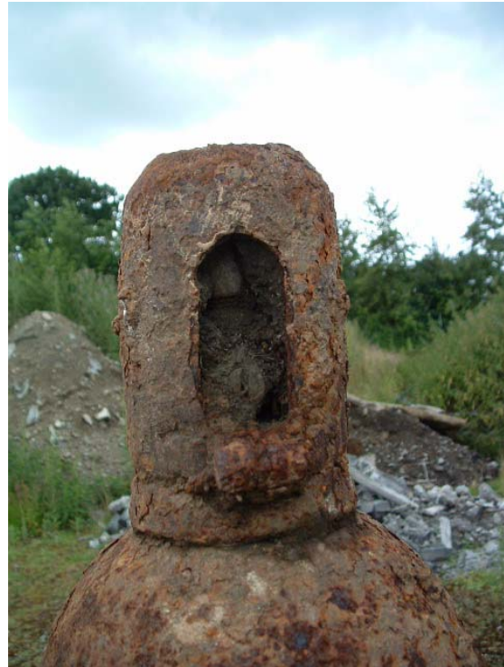
Beispiel einer stark korrodierten Gasflasche, die Gas unter hohem Druck enthält.
