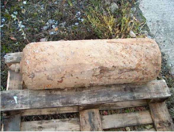
Beispiel einer bedenklichen, sehr stark verrosteten Gasflasche, die wahrscheinlich giftiges Gas unter Druck enthält.
