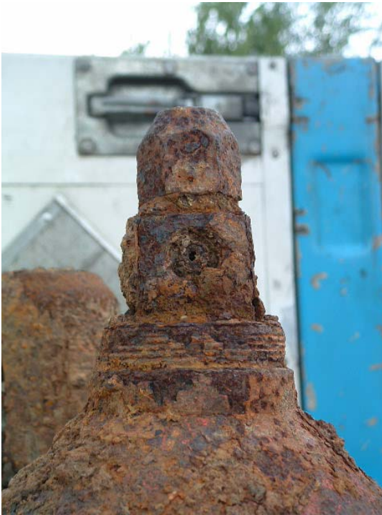
Beispiel einer stark korrodierten Azetylen-Gasflasche.
